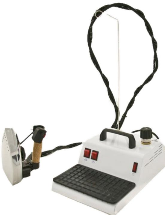
Come in tutti gli altri modelli Stirafacile, anche nella macchina IRON STIR la caldaia è in rame. Le resistenze sono esterne alla caldaia e non immerse nell'acqua. Queste soluzioni tecniche permettono di eliminare i problemi di usura e di risparmiare elettricità, riducendo al minimo i tempi di attesa.
